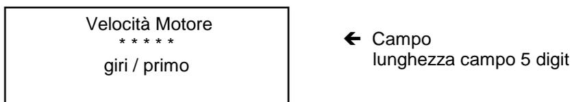
La parte di display in cui viene visualizzato il valore della variabile PLC è il CAMPO di una Funzione. Le Funzioni di Lettura e di Scrittura hanno sempre un campo sul display mentre le Funzioni di Preset e di Slave non hanno nessun campo.
