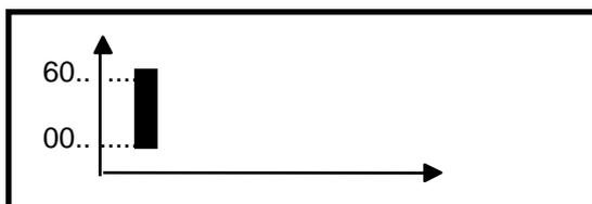
La variabile al valore 0 viene visualizzata con un segmento nullo ed al valore di 60 viene visualizzata con un segmento alto 3 caratteri e largo un carattere.
